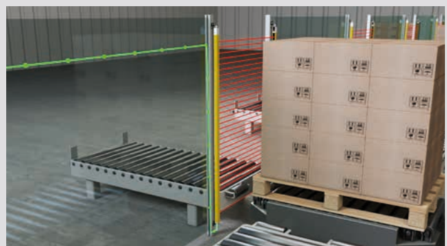
Smart Process Gating an einer Förderstrecke
